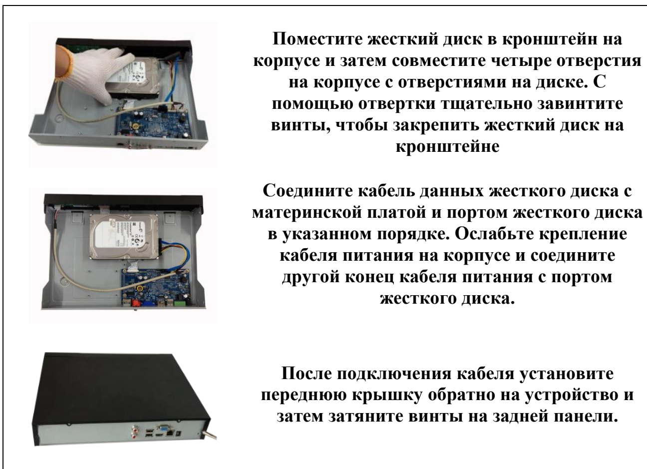
Рисунок 5.1 Установка жесткого диска
