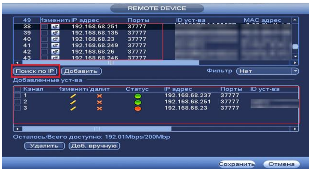
Рисунок 7.31 Настройка добавления камер по поиску в сети.
