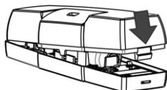
**10** ДУВ разместить на полу контактными площадками вниз в наиболее низком месте помещения, где необходимо контролировать возможность затопления (с учетом направления стока воды в случае прорыва водопровода или системы отопления). Закрепить ДУВ с помощью монтажного скотча на основании
